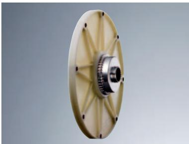
Les accouplements BoWex® FLE-PA sont des accouplements à denture bombée, rigides en torsion. Constitués de nylon et d'acier, ils sont particulièrement indiqués pour l'entraînement de pompes hydrauliques en liaison avec des moteurs diesel.
