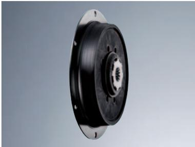
Le MONOLASTIC® est un accouplement monobloc en caoutchouc naturel, élastique en torsion. Le moyeu acier prémonté en usine présente une denture intérieure traitée qui permet un montage axial de la pompe hydraulique. Accouplement disponible avec tout type de cannelures SAE et DIN.
